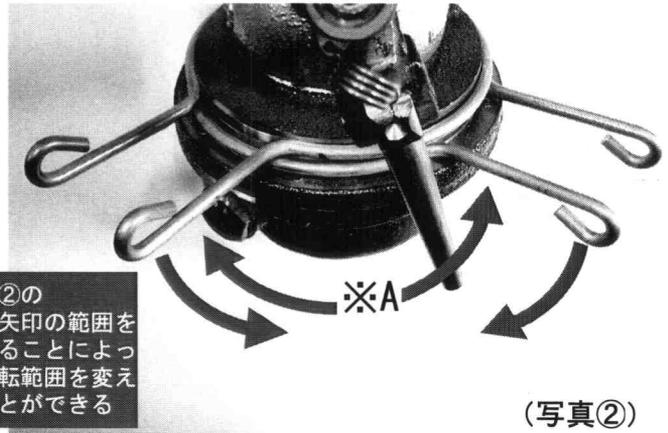
2本の角度調整リング(写真①)の、切換レバーをはさんでいる方の範囲を変えること(写真②)によって散水範囲(回転範囲)を決めることができます。散水範囲の確認のやり方はスプレーガン本体を手で左右に動かすことにより、どの範囲を散水するかが確認出来ます。
