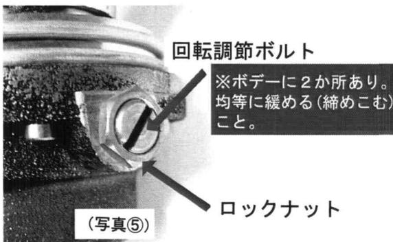
回転速度を早くする場合、(写真⑤)のロックナットをスパナなどで緩め、その後、回転調節ボルトをマイナスドライバーで緩めます。
